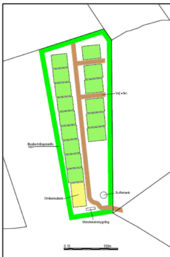
Figur 2 Påtænkt indretning af slammineraliseringsanlægget
